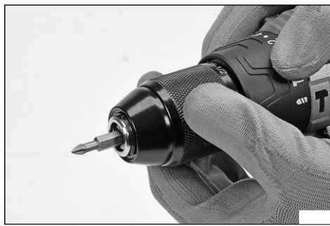
Postavljanje bita u steznu glavu
