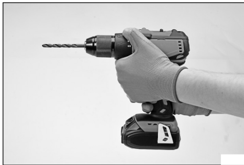
Pravilno držanje uređaja tokom rada
