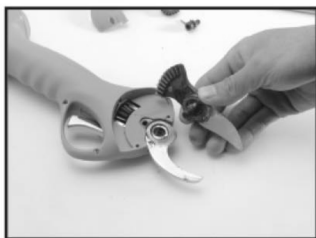
Izvadite pin i skinite pokretno sečivo
