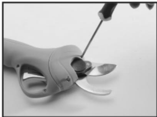
Odvrnite vijke odvijačem i otvorite poklopac.
