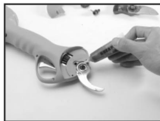
Prilikom zamene sečiva, potrebno je dodati ulje za podmazivanje između sečiva
