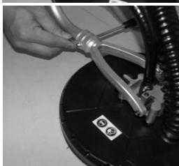
Stavite zavoju aluminijsku cev u rupu, a zatim je pričvrstite vijkom i maticom.
