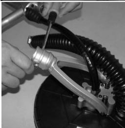
Pričvrstite maticu pomoću ključa, a zatim odvignite vijak pomoću odvijača.
