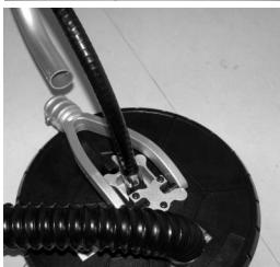
Postavite aluminijumsku cev ispod pogonske sajle. Postavite pogonsku sajlu u rupu u sredini plastične ploče.
