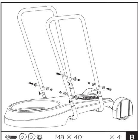
Postavite sklop kućišta na okvir nosači cevi, poravnajte rupe za montažu.
