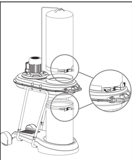
Priklučite spojnicu creva na usisni otvor na kućištu.
