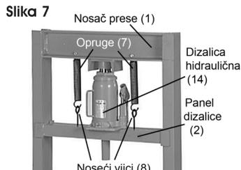
9. Ubacite vijke (10) kroz gornji deo nosača prese i pričvrstite ih navtkama (11). Zatim na vijke postavite opruge (7) (slika 6).
