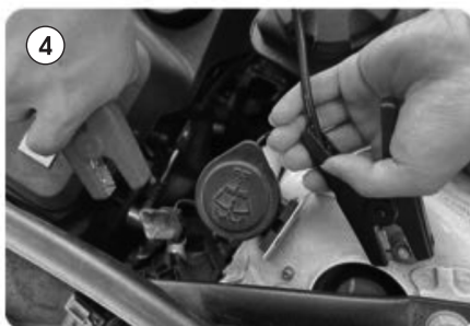
4. Uklonite stezaljku nakon pokretanja.
