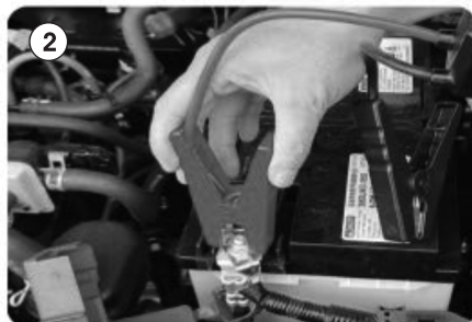
2. Crvena stezaljka na pozitivni (+) pol, crna stezaljka na negativni (-) pol akumulatora.
