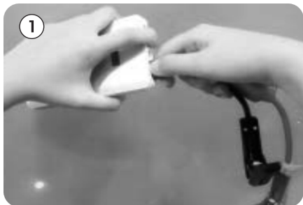
1. Priključite kabl na starter
