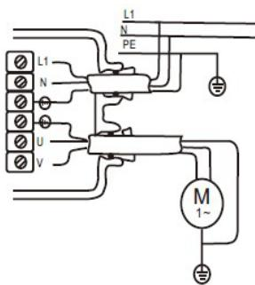
Šema za povezivanje monofaznih 110V / 220V pumpe do 0,55kV/ 1,1 Kv.
