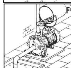
Prvo punjenje: Napunite pumpu u potpunosti sa čistom vodom pre nego što je uključite. Voda treba da se sipa u otvor na kućištu pumpe pored izlaznog otvora. Kada ste završili sa punjenjem, zavrnite čep na otvor za sisanje vode i uključite pumpu. (slika F) Ovaj postupak morate ponoviti svaki put kad pumpa ne radi duže vreme ili kada je ušlo vazduha u sistem.
