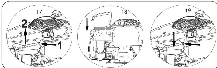
**Upozorenje:** Nikada nemojte pokretati motor bez ugradenog elementa filtera za vazduh.
